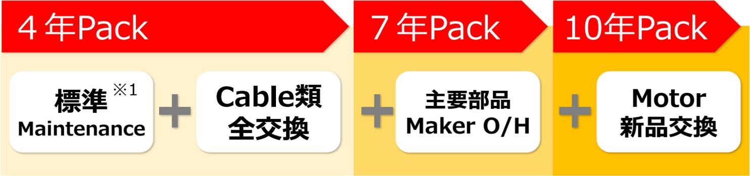
※1 標準Maintenanceには、摺動部のGrease吹き上げ、摩耗状態の確認、Grease Up、固定boltの増締、Timing Beltの状態確認、Tension値電圧(Battery、入力電源、その他)の確認・調整、拭き上げ清掃、および新規製作時と同様の精度検査が含まれます
