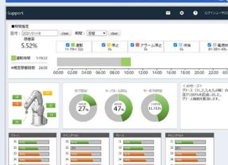
装置の稼働状況、消耗品状態などを cloudの画面で確認できます。trouble発生時は、当社から remoteで接続して原因究明、復旧支援します。
