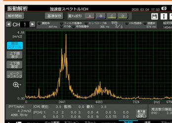
振動sensorなどの dataを解析し、装置に異常を常に監視します。異常検出時には、alarmとして画面に表示します。
