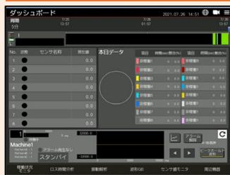
設備状態や sensor波形、alarm情報などを Dashboard画面で表示します。
